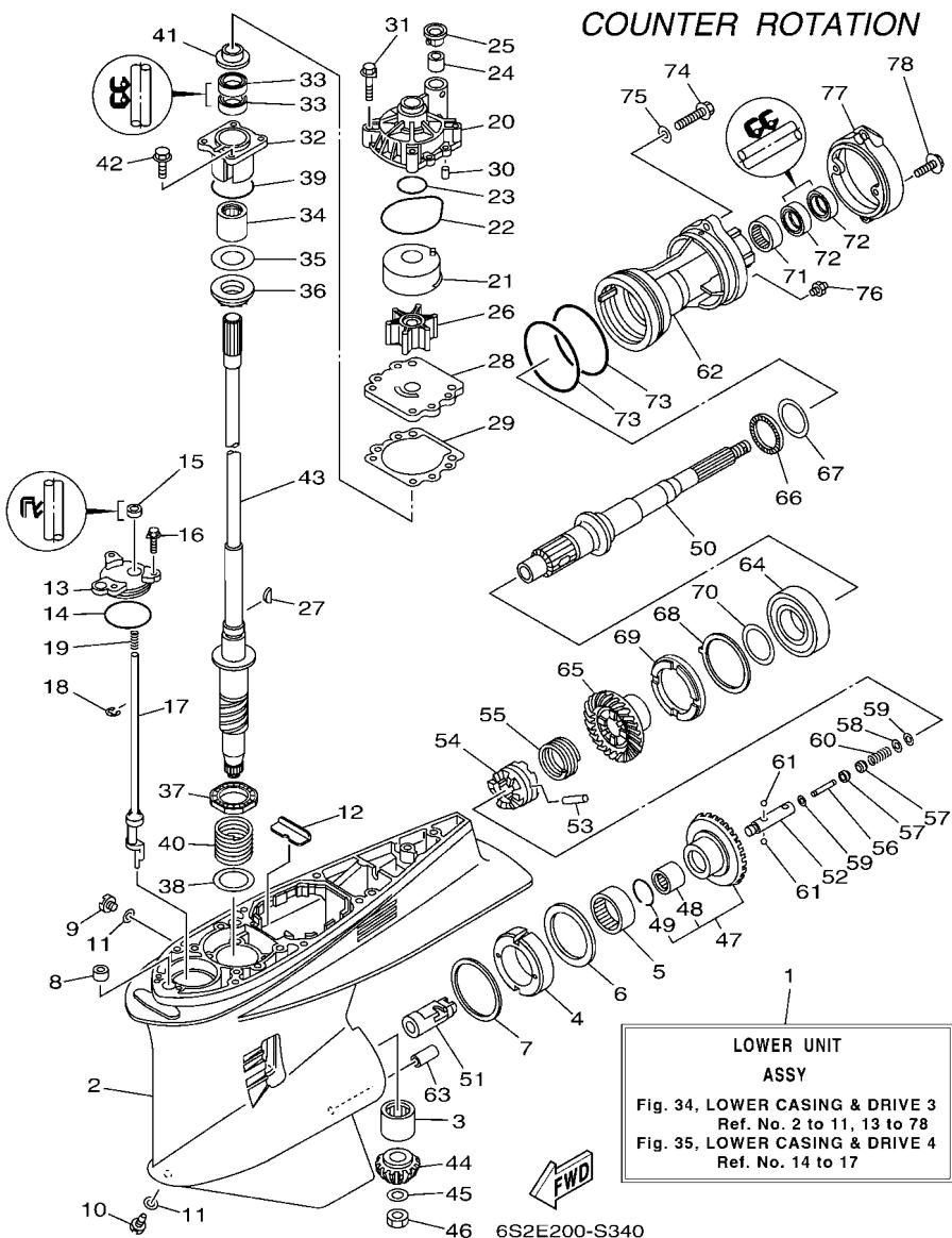
**FIG. 34 LOWER CASING & DRIVE 3**
