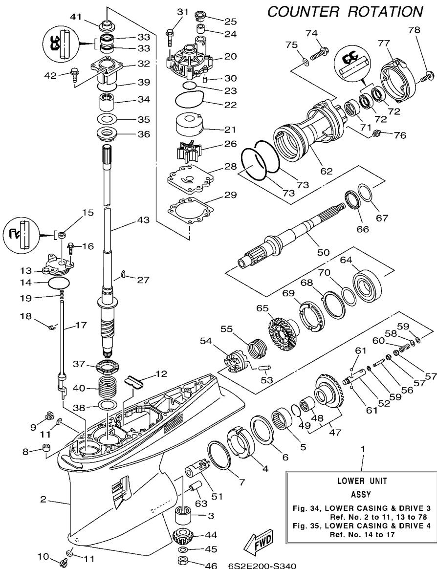
**FIG. 34 LOWER CASING & DRIVE 3**
