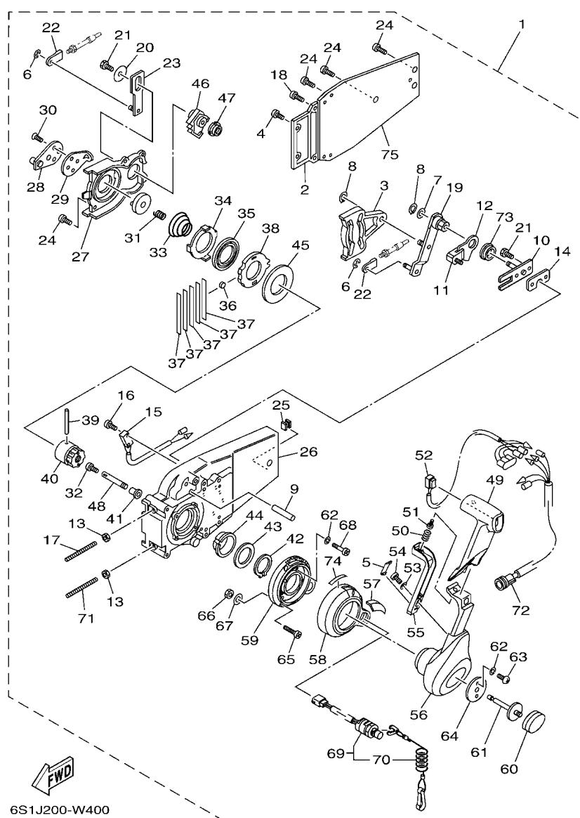
**FIG. 40 REMOTE CONTROL ASSY 2**      **CONTROL REMOTO COMPL 2**
