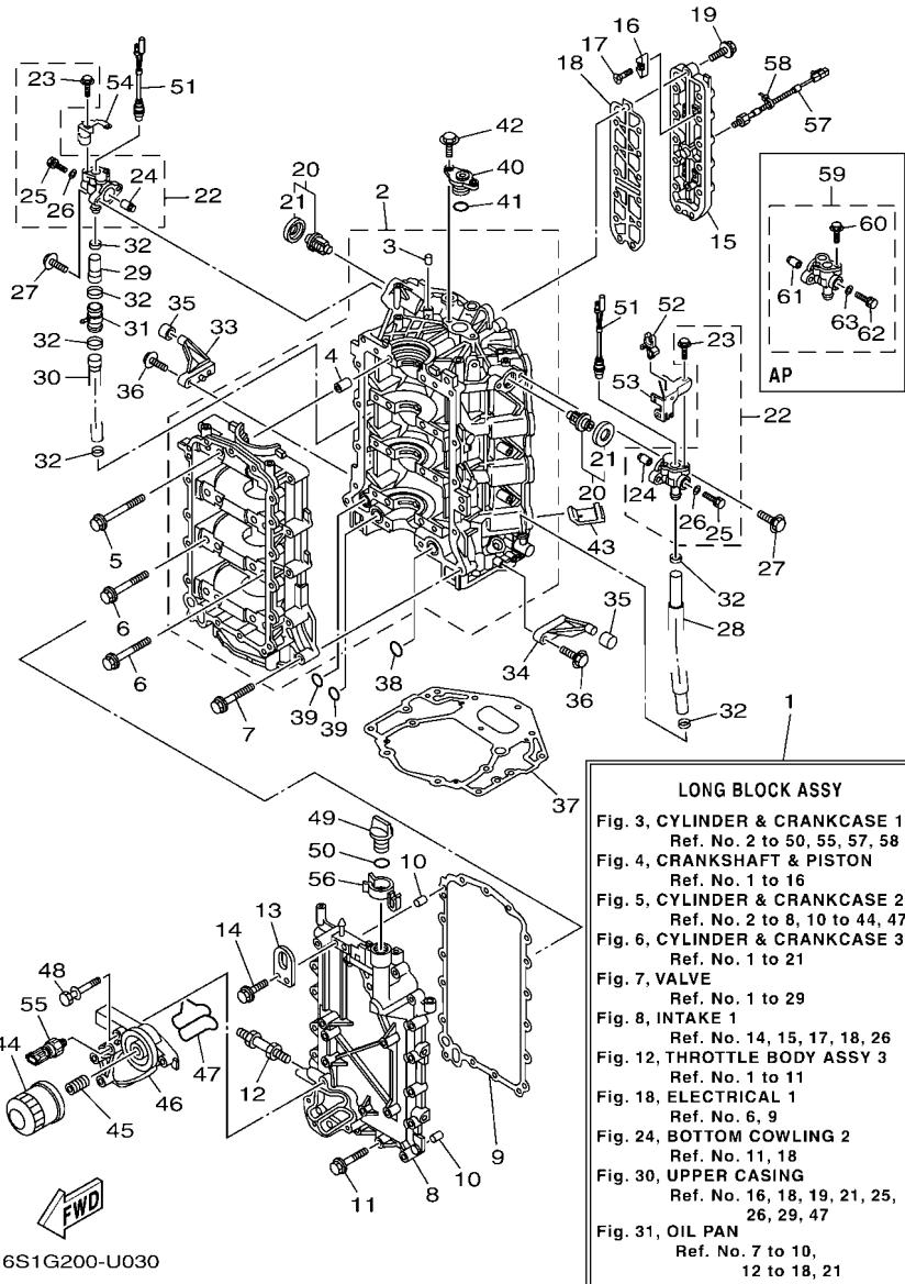
**FIG. 3 CYLINDER & CRANKCASE 1** **CILINDRO & CARTER 1**
