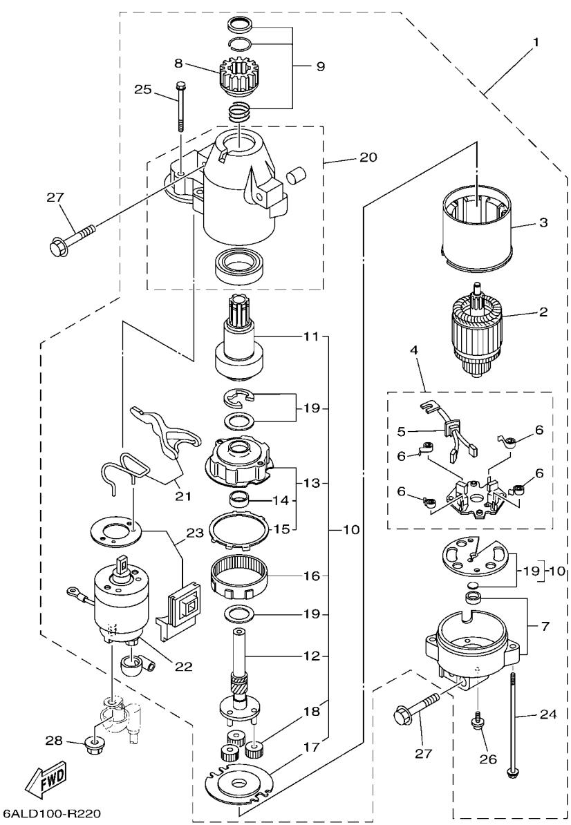
**FIG. 22 STARTING MOTOR**
