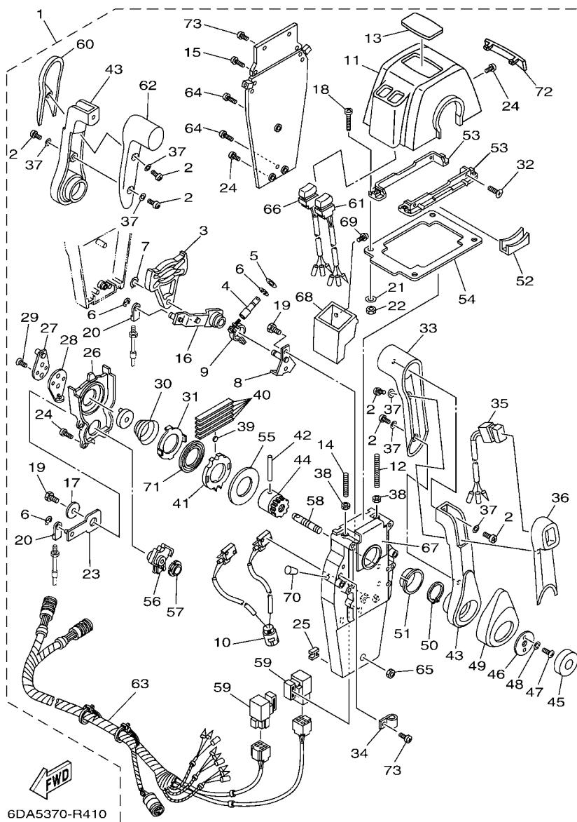
**FIG. 42 REMOTE CONTROL ASSY 4** **CONTROL REMOTO COMPL 4**
