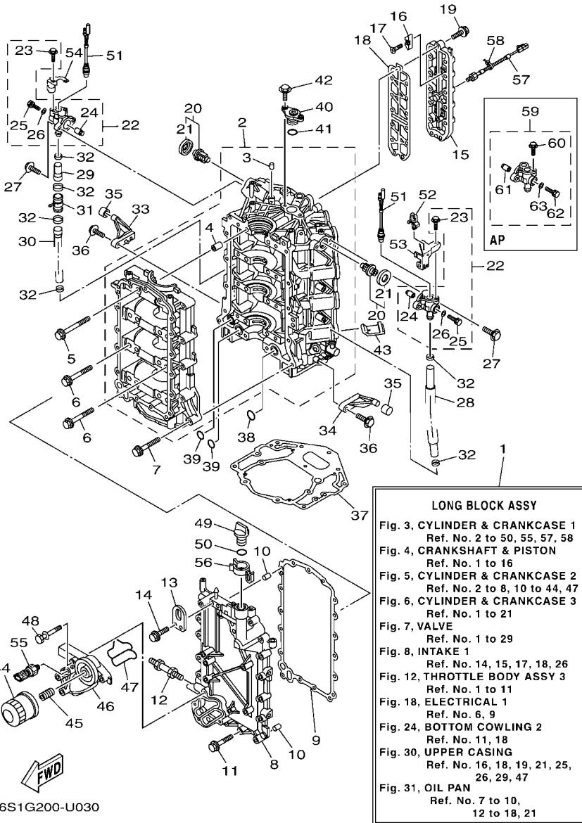
**FIG. 3 CYLINDER & CRANKCASE 1**
