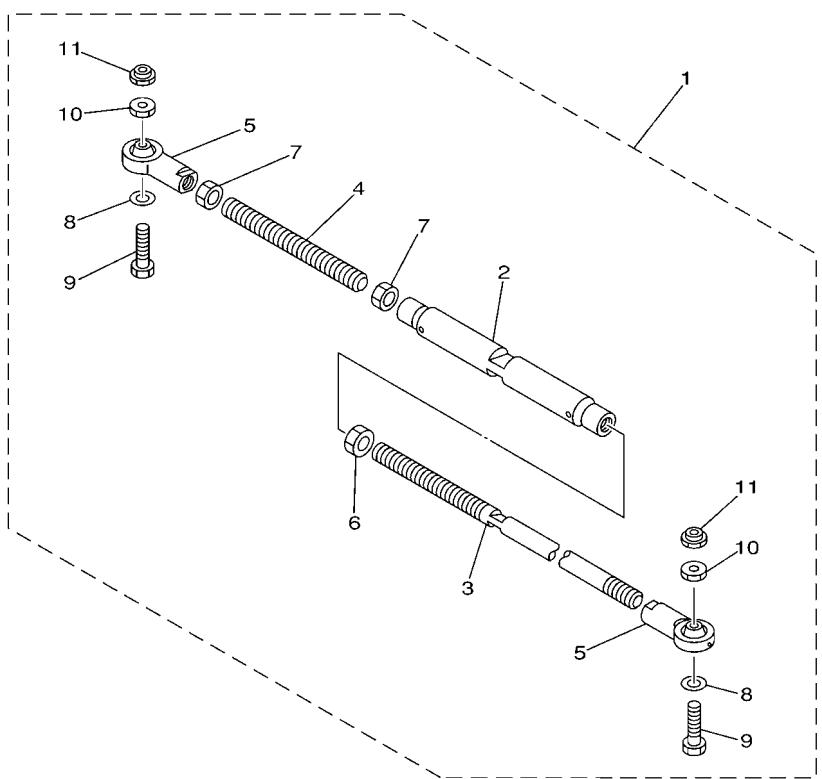
**FIG. 37 STEERING GUIDE ATTACHMENT 2 ADITAMIENTO GUIA DE GOBIERNO 2**
