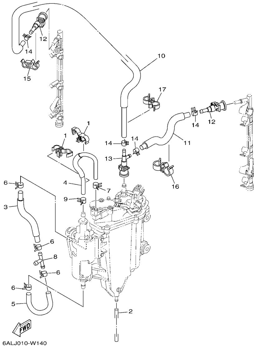
**FIG. 14 FUEL INJECTION PUMP 2**
