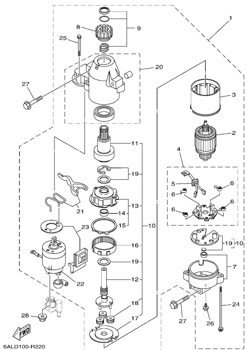
**FIG. 22 STARTING MOTOR**
